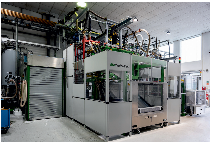
Bild 2. Formteilautomat EMMotion Flex im Technikum: Im Erlenbach Experience Center können Anwender und Materialhersteller auf neuesten Maschinen Versuchsreihen fahren. © Siemens
